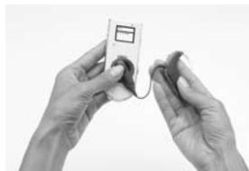
Afbeelding 10: De zendspool op de achterkant van de afstandsbediening plaatsen
