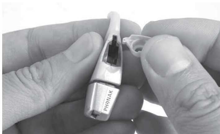
Afbeelding 30: Installeren van een nieuw batterijcompartiment.
