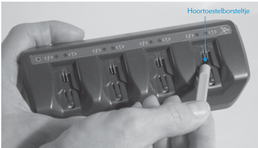
Afbeelding 16: Reinigen van de oplader.
