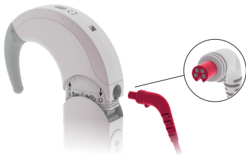
Afb. 27 Inpluggen van de spoelkabel in de controle-eenheid
