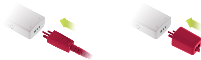
Afb. 41 Aansluiting van de adapterkabel en direct-link FM-systemen
