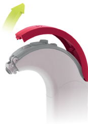
Afb. 39 Het microfoonkapje verwijderen
