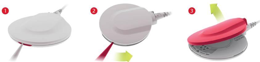
Afb. 14 Het spoelkapje verwijderen
