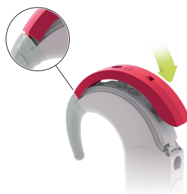
Afb. 38 Het microfoonkapje bevestigen
