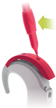
Afb. 37 Het microfoonkapje verwijderen
