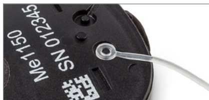
Afb. 13 De bevestigingsclip op de behuizing van de audioprocessor vastzetten
