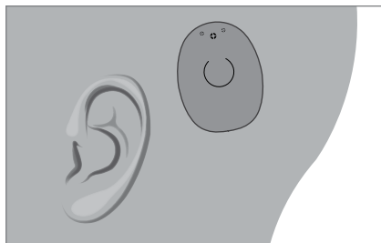
Afb. 3 audioprocessor over de implantaatlocatie. Let erop dat de microfoon naar boven is gericht.
