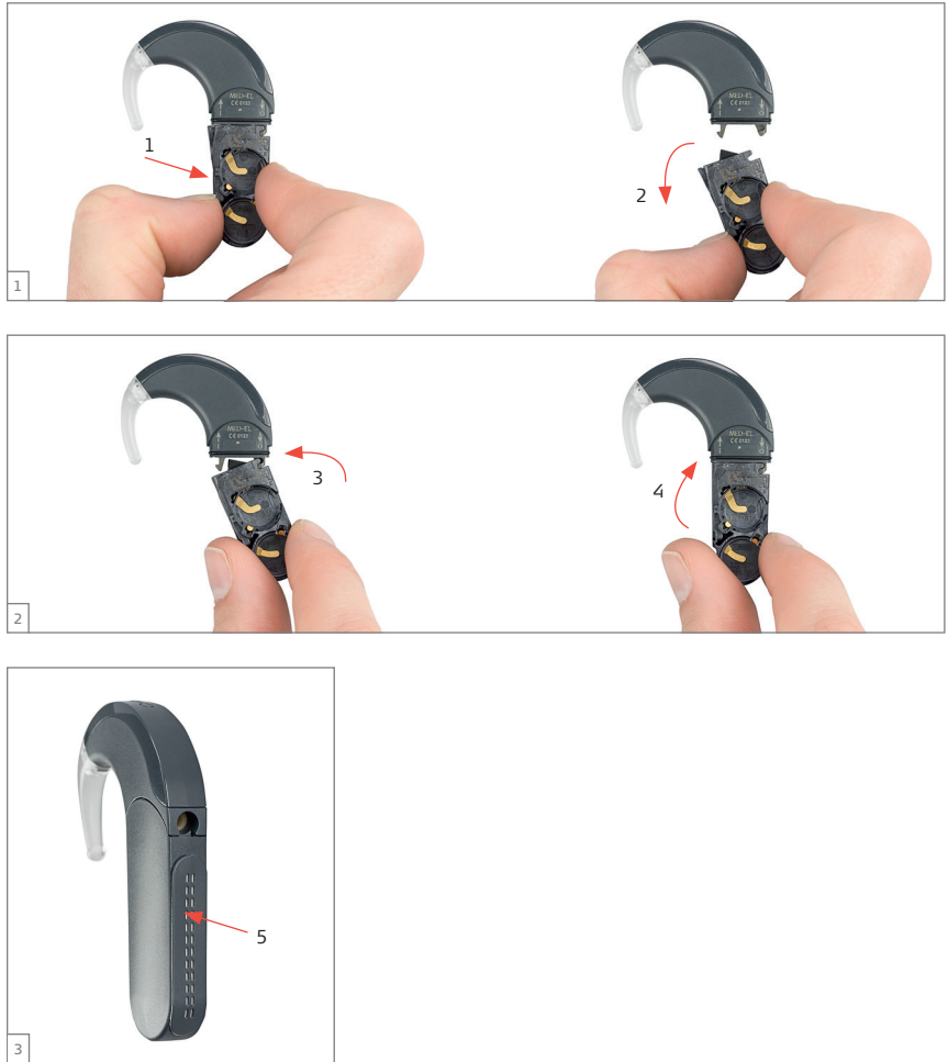
Fig. 8 Hoe u de batterijhouder moet verwijderen van/plaatsen op de controle-eenheid
